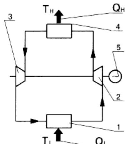
43. На рисунке приведена схема ... теплового насоса.
