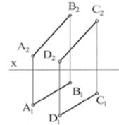
3. Определить расстояние между параллельными прямыми. Задачу решить способом замены плоскостей проекций.
