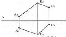
3. Определить угол наклона плоскости, заданной двумя пересекающимися прямыми  $AB$  и  $BC$  к горизонтальной плоскости проекции.
