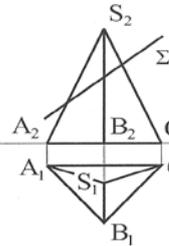
4. Построить проекции сечения пирамиды плоскостью и развертку боковой поверхности с нанесением линий сечения.
