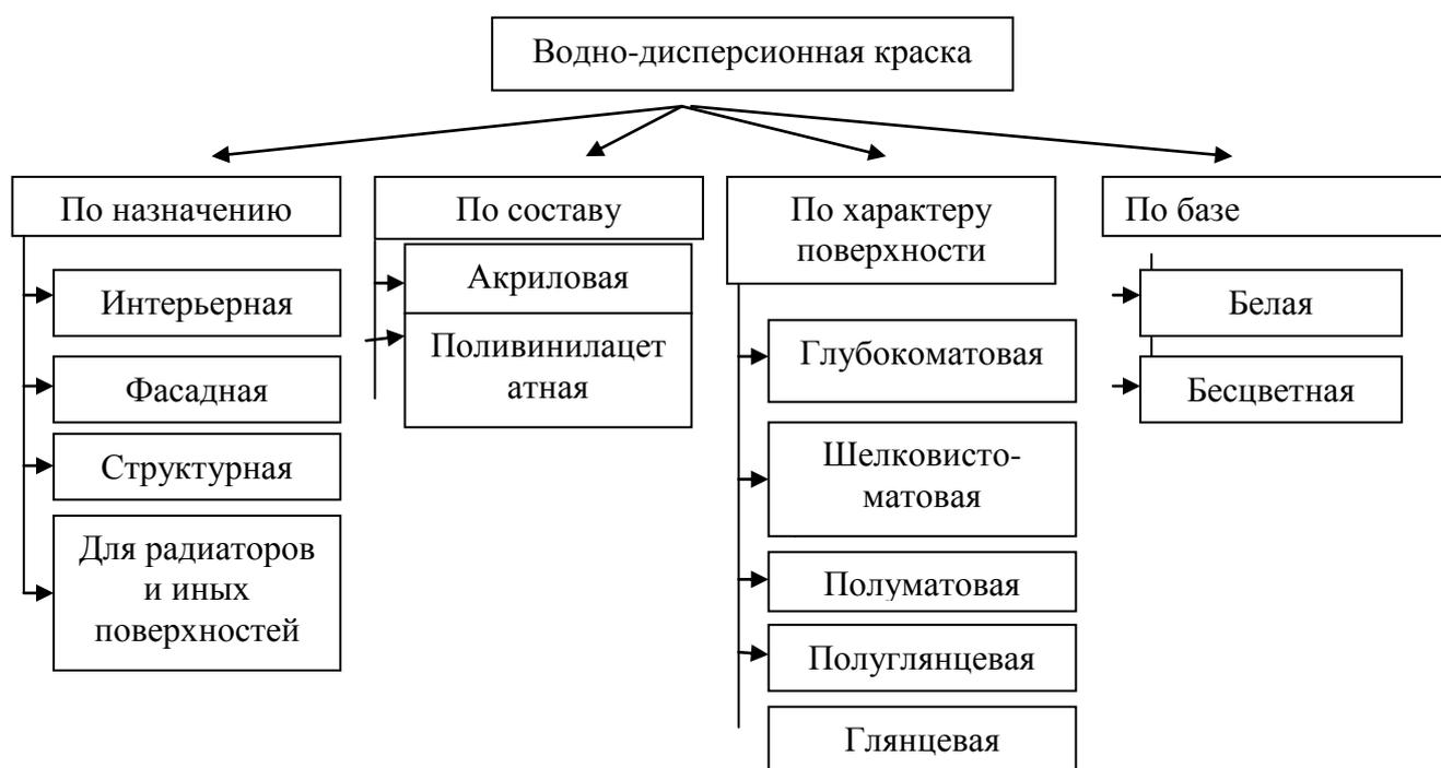
Рис 1 – Классификация водно-дисперсионных ЛКМ
