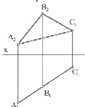
3. Определить расстояние между параллельными прямыми. Задачу решить способом замены плоскостей проекций.
