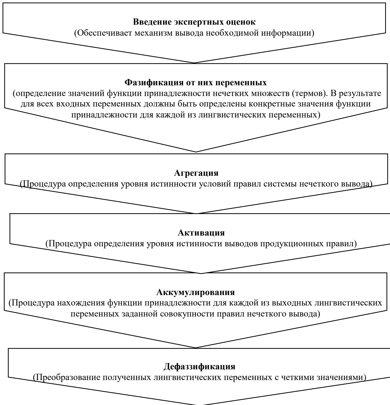
Рисунок 5.9 – Механизм формирования нечеткого логического управленческого вывода
