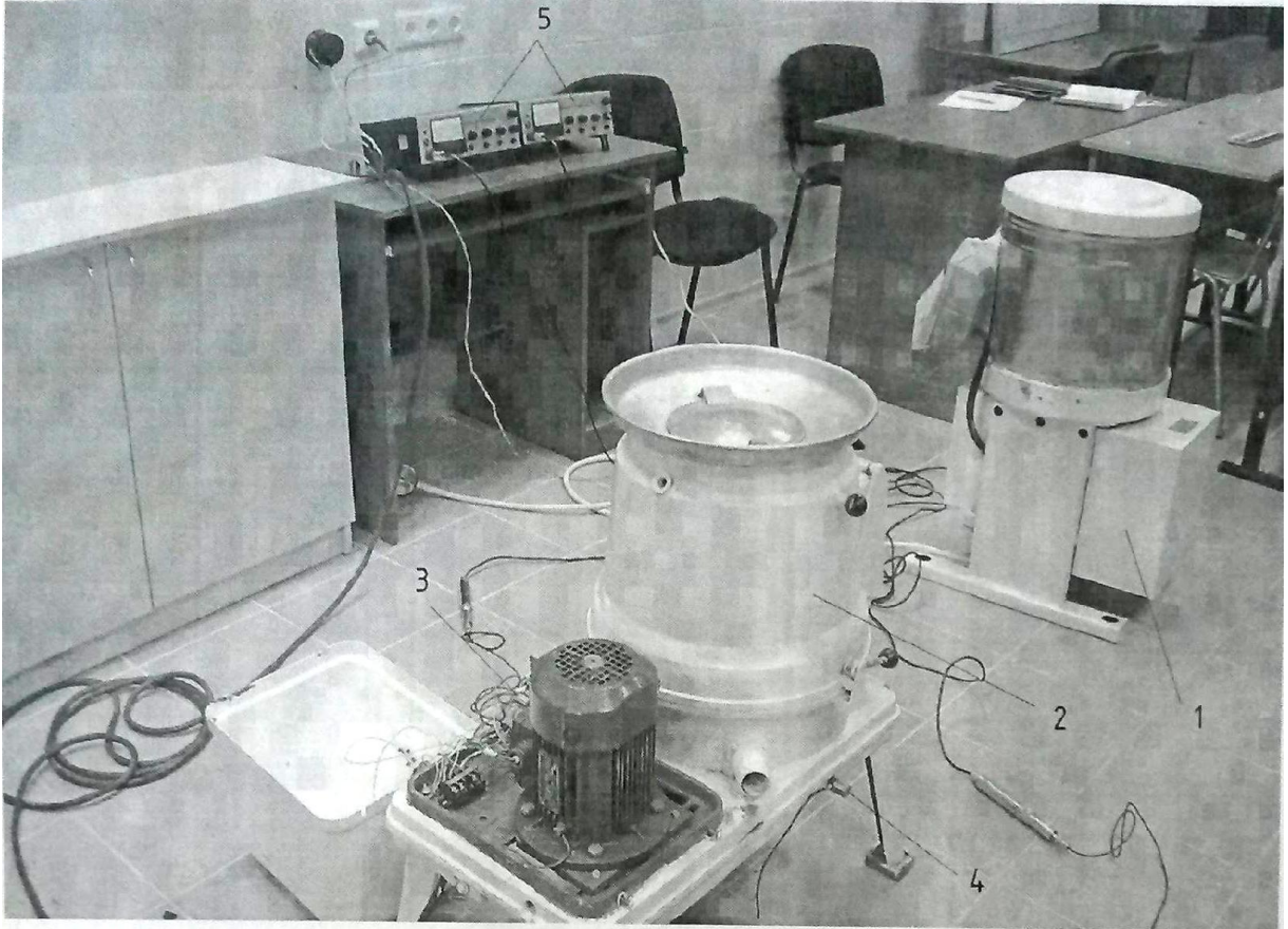
Рисунок 4.4 – Стенд для измерения вибрационных характеристик картофелечисток
