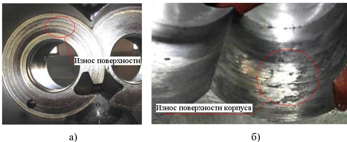
Рисунок 1.9 – Повреждения корпуса: а) износ поверхности задней крышки; б) износ цилиндрической поверхности корпуса
