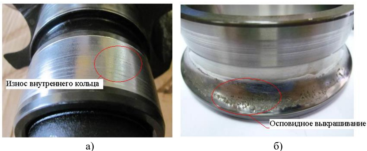
Рисунок 1.8 – Повреждения подшипников качения: а) износ внутреннего кольца; б) осповидное выкрашивание беговой дорожки внутреннего кольца
