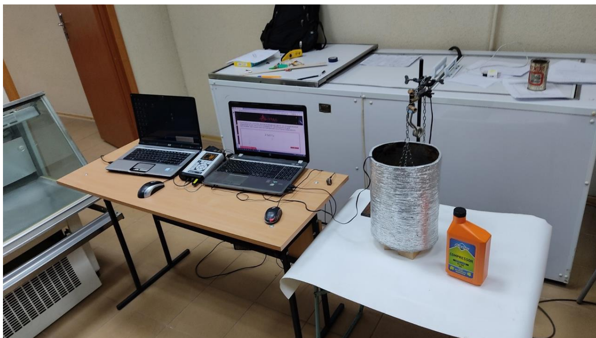
Рисунок 3.2 – Экспериментальный стенд по определению СКЗ виброускорения, проходящего через масляную ванну
