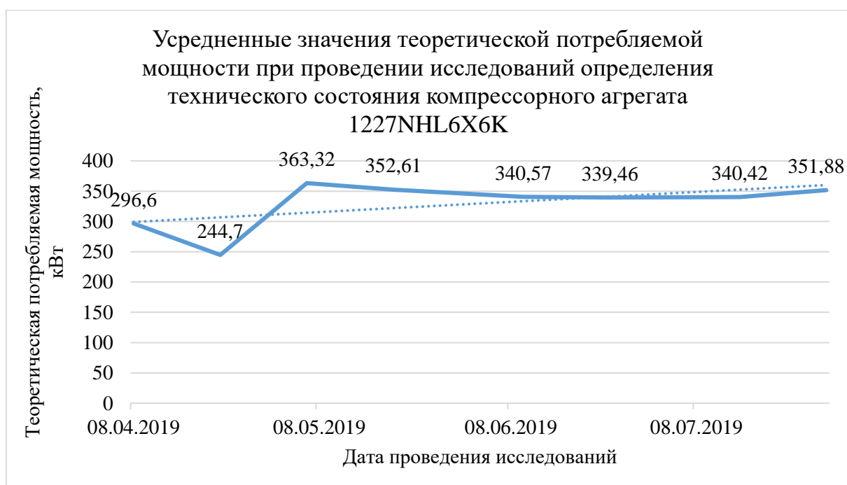
Рисунок 5 - Результаты проведения технической диагностики компрессорного агрегата с 08.04.2019 по 29.07.19 по усредненным значениям теоретической потребляемой мощности компрессора 1227NHL6X6K
