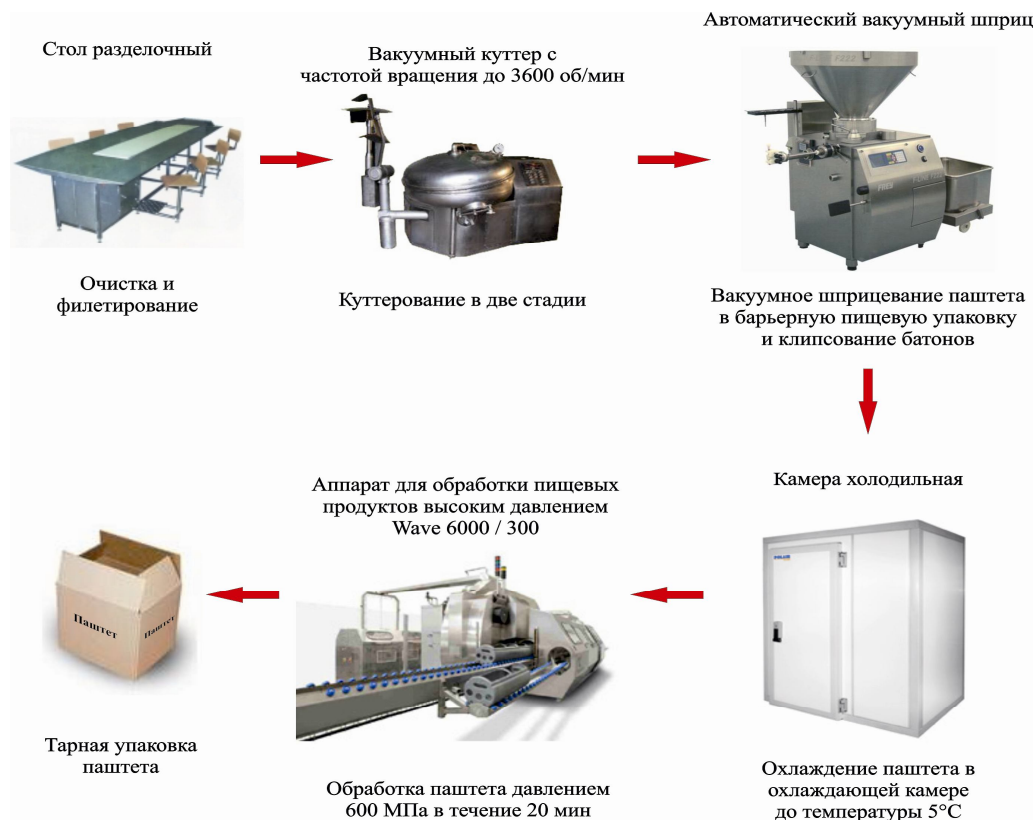
Рис. 6.3. Аппаратурно-технологическая схема производства рыбоовощного паштета нетепловым способом с использованием ВД.
