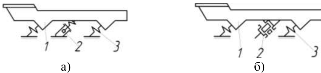
Рис. 1.2. Структурные схемы вибрационных транспортирующих машин с пневматическим виброприводом
