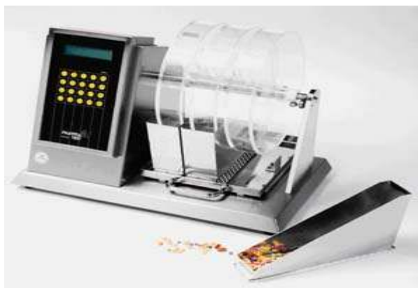
Рис. 1.9. Автоматический тестер хрупкости и истираемости трёхбарабанный.
