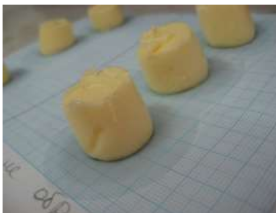
Рис. 4.1. Образцы СМ в процессе определения их термоустойчивости
